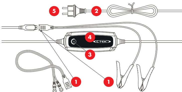
4. Beachten Sie die 7-stufige Anzeige während des Ladevorgangs. Sobald SCHRITT 4 leuchtet, ist die Batterie zum Starten eines Motors bereit. Die Batterie ist vollständig geladen, sobald SCHRITT 6 leuchtet.
